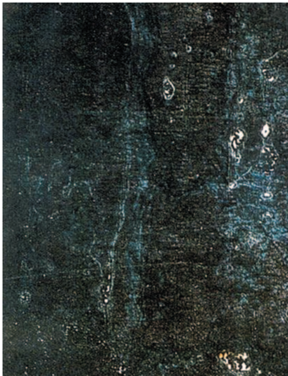
Afb. 8a en b. Nieuw constructiestaal is bedekt met een walshuid. Wanneer dit staal buiten of in een vochtige omgeving wordt opgeslagen, zal er roest ontstaan. NEN-EN-ISO 8501-1 onderscheidt vier staalklassen (A, B, C, D) op basis van roestgradaties. Bij staalklasse A en B kunnen de verontreinigingen nog goed door stralen worden verwijderd.
