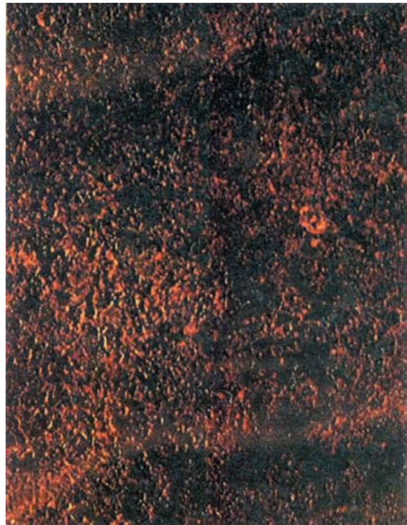
Afb. 8a en b. Nieuw constructiestaal is bedekt met een walshuid. Wanneer dit staal buiten of in een vochtige omgeving wordt opgeslagen, zal er roest ontstaan. NEN-EN-ISO 8501-1 onderscheidt vier staalklassen (A, B, C, D) op basis van roestgradaties. Bij staalklasse A en B kunnen de verontreinigingen nog goed door stralen worden verwijderd.
